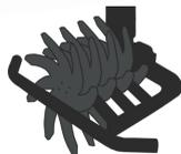
La **rollhacker** ad azionamento **idraulico** consente un lavoro perfetto indipendentemente dalla velocità di guida. La regolazione dell'angolo consente di trasportare il terreno verso o lontano dagli alberi
