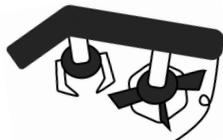
Con il **Krümler** di Ladurner, è possibile lavorare il sottofilare in modo molto piano e in profondità regolabile da 0 a 10 cm. Il metodo di lavoro favorisce la struttura naturale della terra e la mobilitazione dei nutrienti
